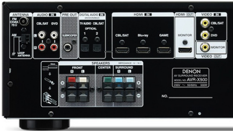
Übersichtliches Angebot an Ein-/Ausgängen (Quelle: DENON-WEBSITE)
